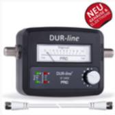
Dur-Line SF-2400 Pro Satfinder Zeigermessgerät mit Anzeige für 22 KHz DiSEQ & 14/18 Volt-Anzeige (Low-Highband)
